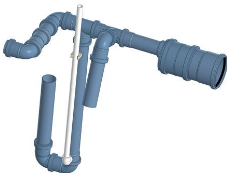
Рисунок 4 - Аэрлифт очищенной воды при принудительном отведении
