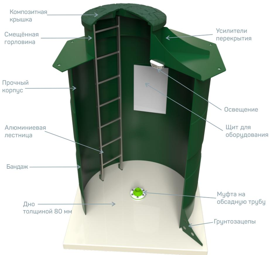
Кессон **Korsu** – «работает» в очень сложных условиях. Он испытывает серьезные внешние нагрузки: давление грунта и гидростатическое давление столба грунтовых вод. Поэтому мы обеспечили избыточную прочность стенок кессона и его дна.
